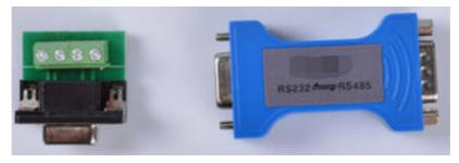
上图中左边的连接器连接至 RS485 总线。 a 图中的绿色线根据现场布线情况决定是否连接。
